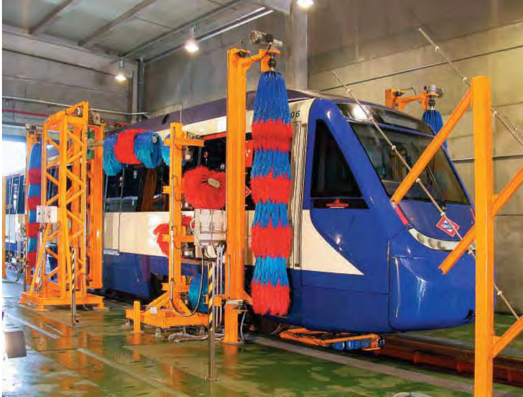
Túnel de lavado al paso con carro de arrastre de Cuatro Vientos
