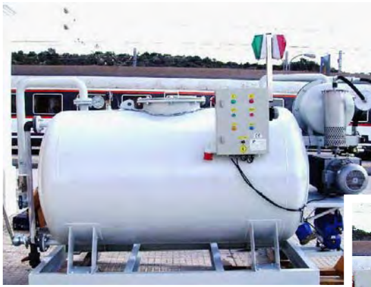
Máquina de vaciado de W.C.
