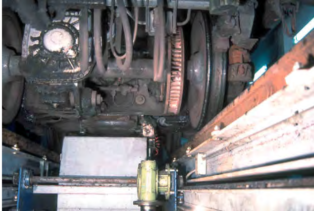
Carro de fondos soplando motores
