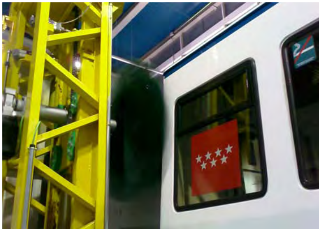
Cepillo en proceso de lavado de huecos entre vagones
