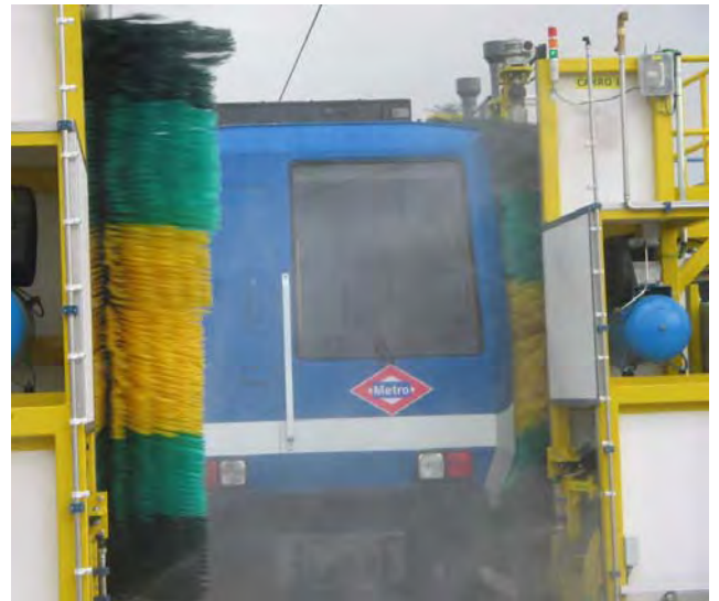
Cepillos de laterales en proceso de lavado
