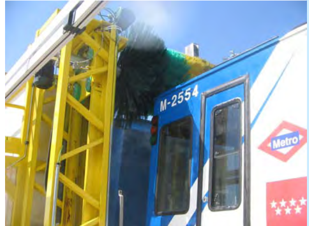
Cepillo horizontal iniciando el lavado de huecos
