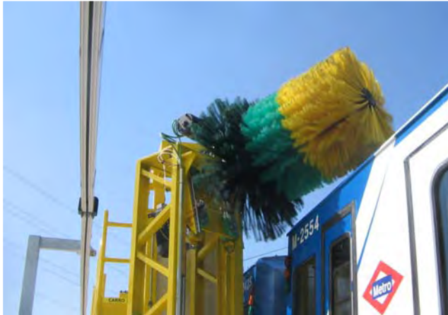
Cepillo horizontal posicionándose para realizar el lavado de huecos
