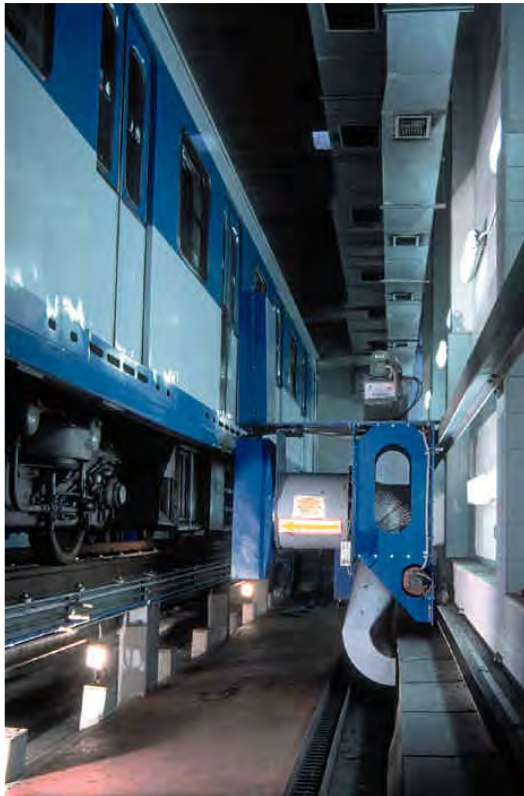
Carro L2 soplado cofres
