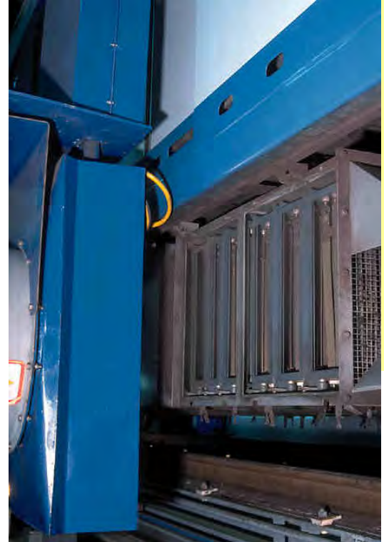
Carro L1 soplando resistencias de frenado
