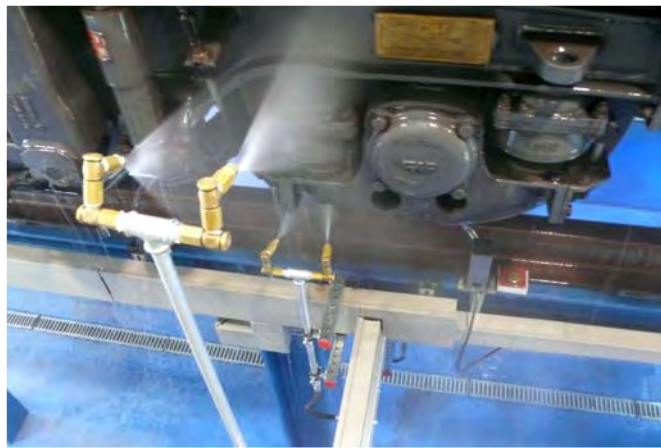
Arcos de boquillas para aclarado de bogies con agua fría
