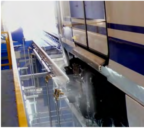
Arcos de boquillas para enjabonado de bogies con agua caliente
