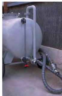
Cuba de acero y conexiones
