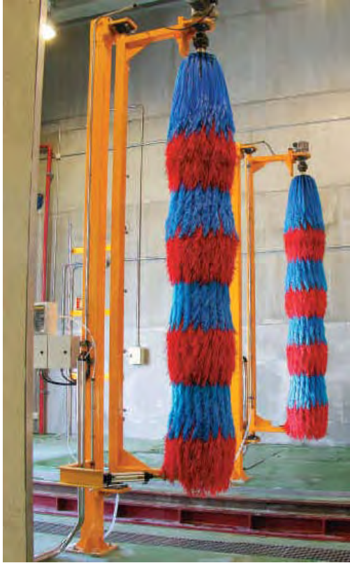
Cepillos de prelavado para laterales de tren
