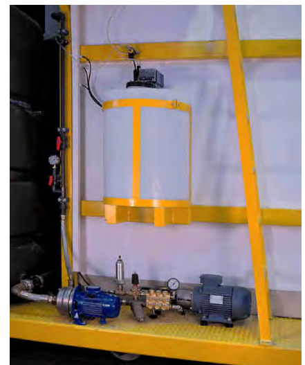
Detalle de depósito de detergente y bombas de alta presión
