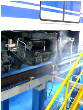
Arcos de boquillas para aclarado de bogies con agua fría
