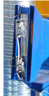
Boquillas de soplado de laterales
