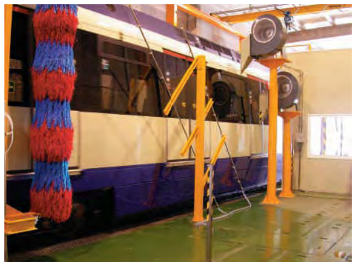
Fase de encerado y secado
