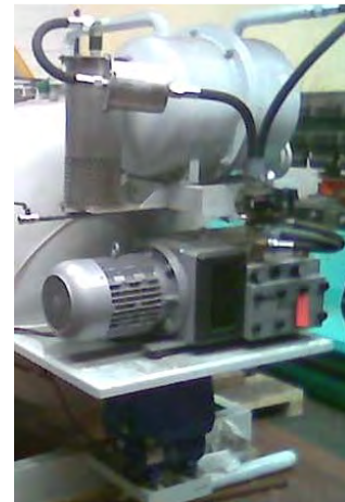
Detalle de compresor-depresor, compresor neumático y filtros
