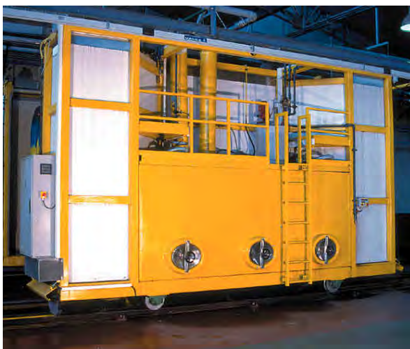
Vista frontal de los depósitos de agua de red y agua reciclada de carros de lavado
