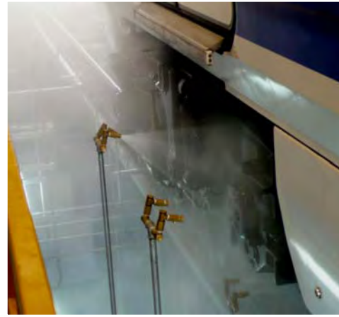
Arcos de boquillas para enjabonado de bogies con agua caliente
