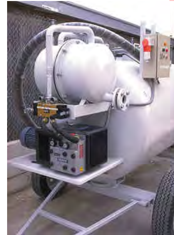
Detalle de compresor-depresor eléctrico
