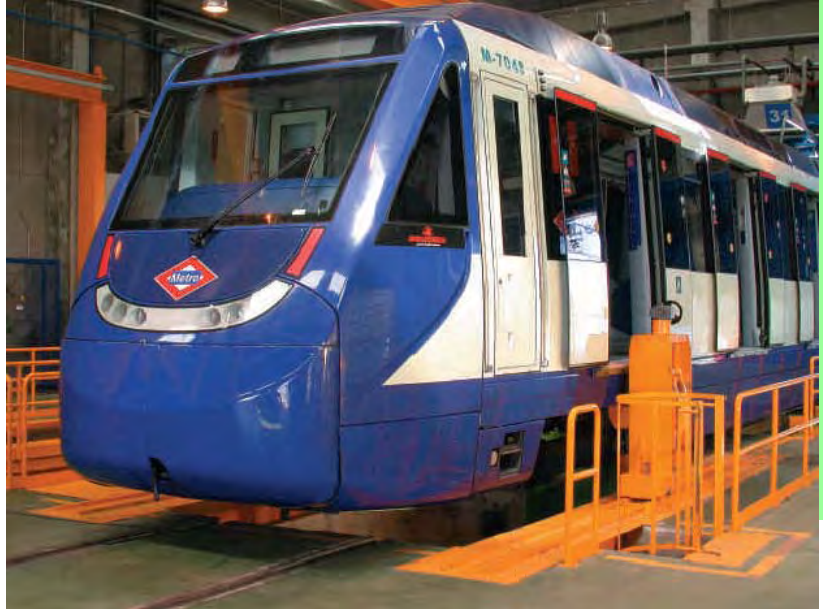
Detalle de la mesa del gato auxiliar
