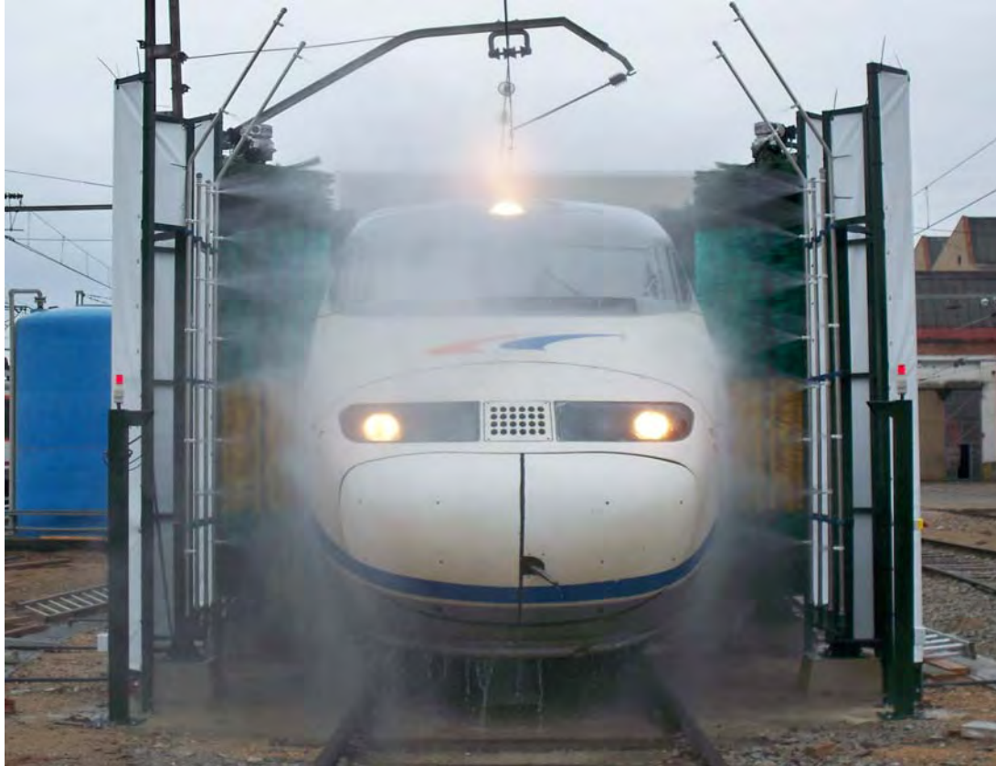
Túnel de lavado al paso de Trenes EUROMED
